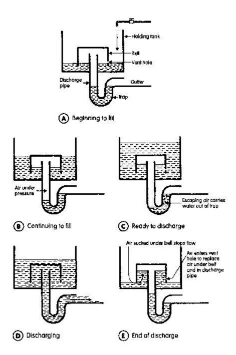
Fig. 10.1. A flushing siphon.
